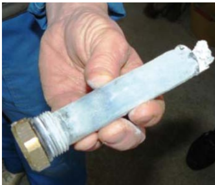
L'anode sacrificielle se corrode dans le temps et doit être changée à intervalle régulier en fonction de la qualité de l'eau
