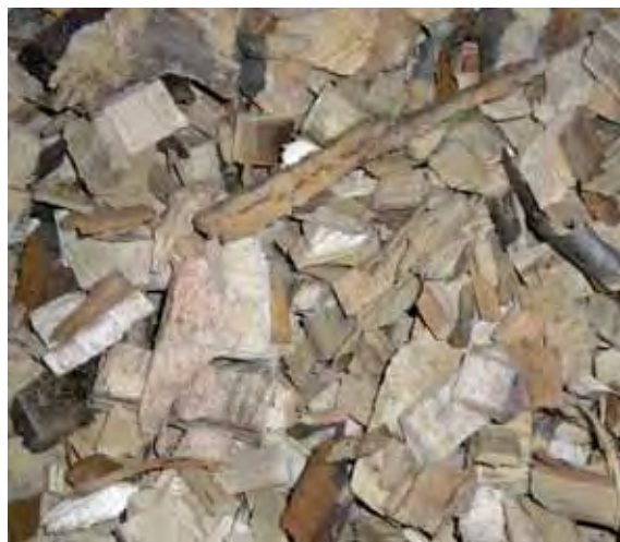
Photo 10 : le bois en plaquette est la forme plus fréquemment utilisée pour la production d'eau chaude
