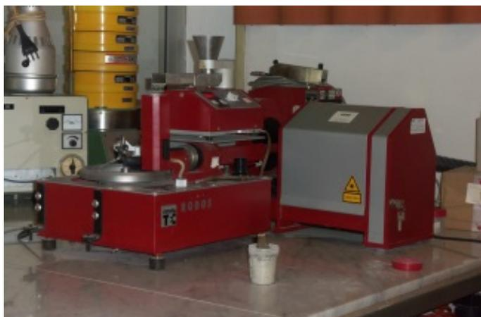
Analyse du ciment. La granulométrie est contrôlée au laser avant injection dans le mélange avec les fibres.
