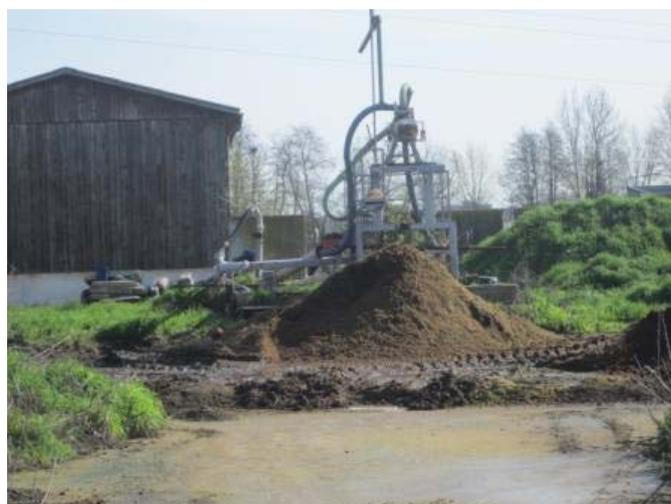
Séparation de phase du lisier, précédée d'un décanteur.
