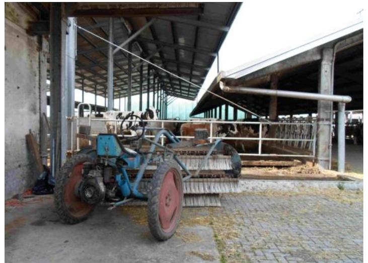
6 rangées de logettes avec matelas et sciure. Un système mécanisé permet le nettoyage des logettes
