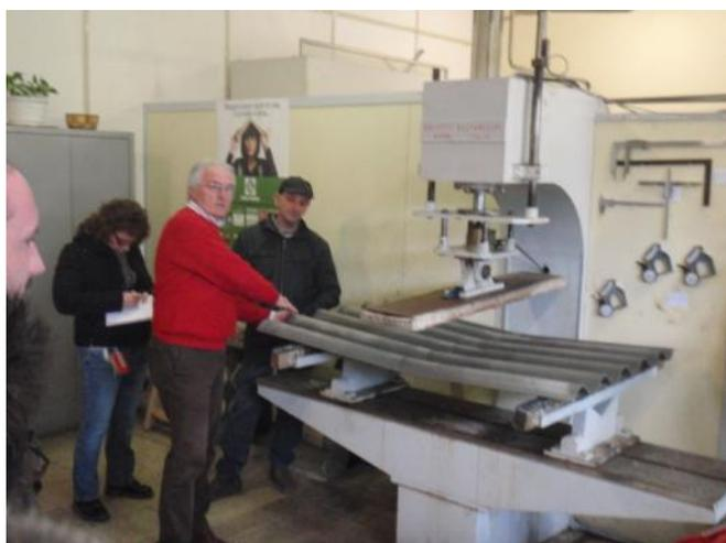
Test de résistance à la cassure. Les plaques sont immergées pendant 24 h. Sous presse, elles doivent résister à 5 000 Newton (norme : 4 250 N).
