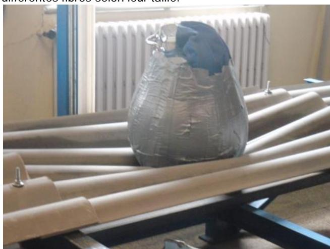
Test de rupture. On soumet la plaque à la chute brutale d'un poids de 50 kg d'une hauteur de 1,20 m. La plaque ne doit pas céder avant 1 mn. Au test, le sac de 50 kg est resté en suspend sur la plaque sans traverser.
